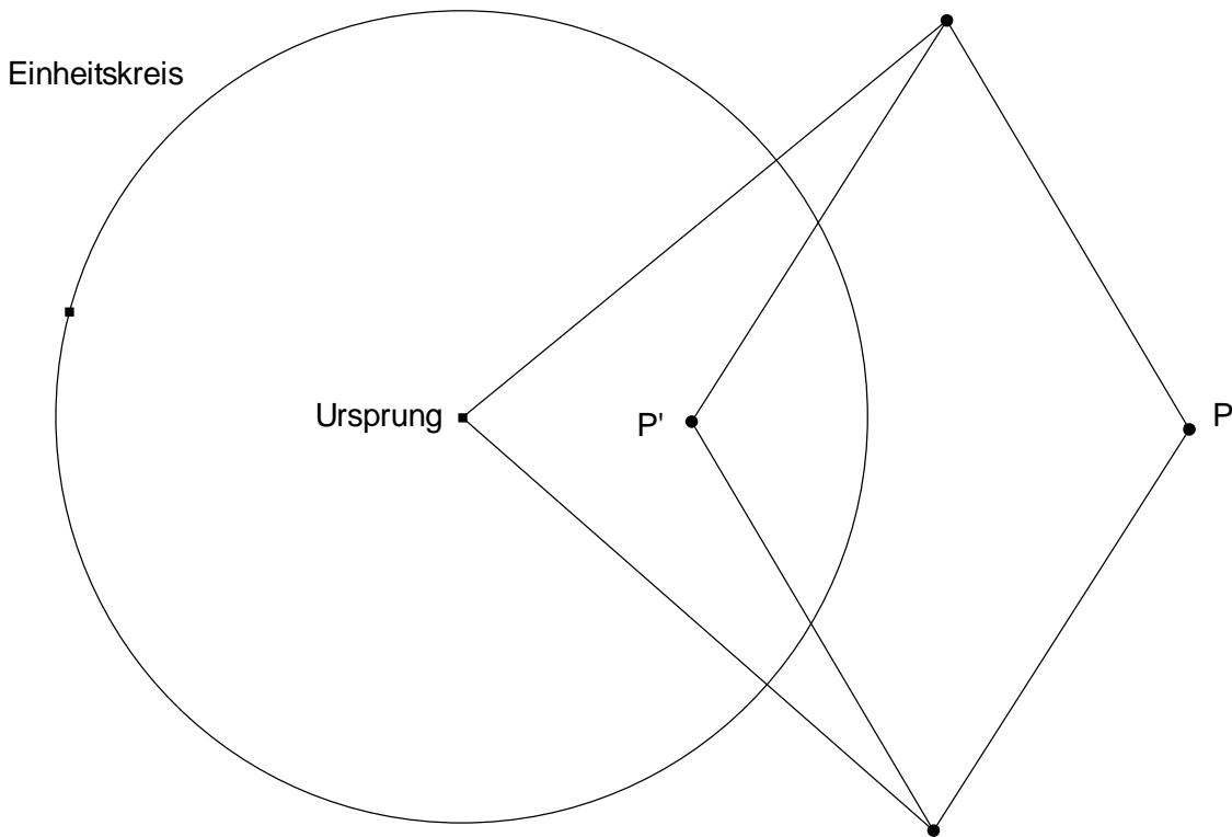
Der Zusammenhang zwischen den Stangenlängen a und b, und dem Kreisradius r ist, wie in der ersten Abbildung gezeigt, durch  $b = \sqrt{a^2 + r^2}$  gegeben.
